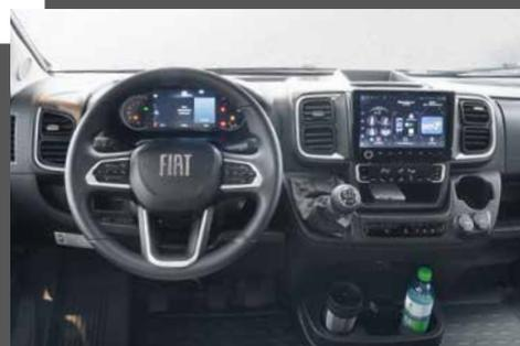
Tableau de bord comprenant un volant gainé de cuir avec éléments de commande, d'un régulateur de vitesse, d'une climatisation de cabine, d'un airbag conducteur et passager, et bien plus encore.
